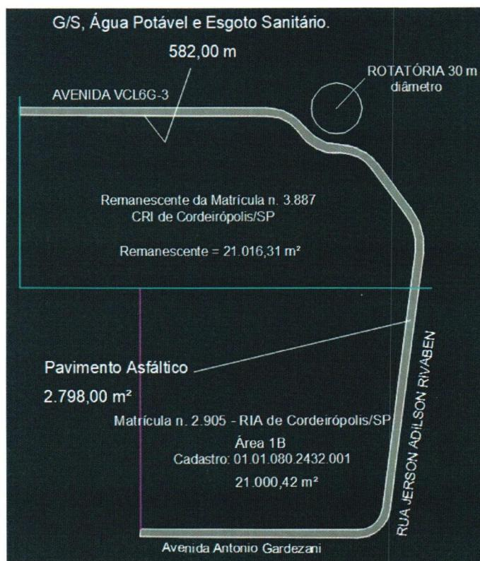
Folha 03/03 da Planta de Infraestrutura com Guias/Sarjetas, Água Potável, Esgoto Sanitário na quantidade de 582 m e Pavimento Asfáltico com 2.798 m<sup>2</sup>.
